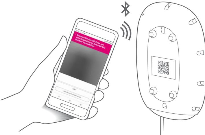
**6. Suchen Sie einen Ort, an dem die 5G/4G-LED aufleuchtet, um eine Mobilfunkverbindung sicherzustellen**
