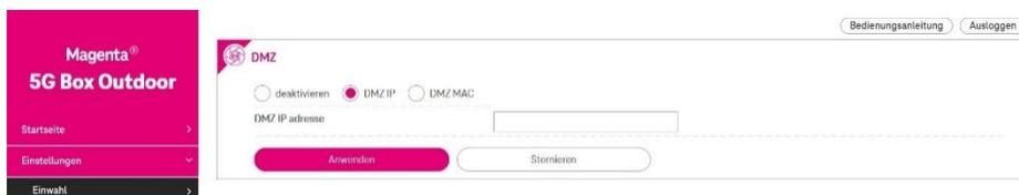
DMZ (De-Militarized Zone) ermöglicht die Angabe einer DMZ-Host-IP zur Umleitung von Anfragen an einen virtuellen DMZ-Host, um die Sicherheit des lokalen Netzwerks zu erhöhen.
