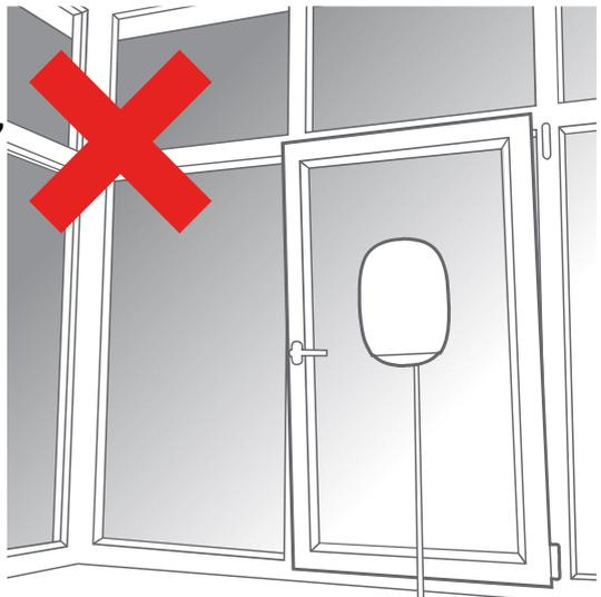
**3. Wir empfehlen, das Gerät oberhalb der Schulterhöhe zu installieren und darauf zu achten, dass sich keine Gegenstände in der Nähe des Geräts befinden, da dies den Signalempfang stören kann.**
