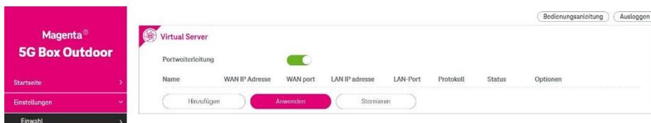
Der Mechanismus des virtuellen Servers/der Portweiterleitung leitet eine Kommunikationsanfrage von einer IP-Adresse zu einer anderen um, während die Pakete einen Router durchlaufen. Dies ermöglicht anderen Computern im Internet, sich aus der Ferne mit einem bestimmten Computer oder Dienst innerhalb eines privaten lokalen Netzwerks (LAN) zu verbinden.
