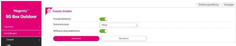
Schieben Sie die Schalter nach rechts auf **Enable Firewall** (Firewall aktivieren) oder **Disable WAN port ping** (WAN-Port-Ping deaktivieren). Wählen Sie **Security level** (Sicherheitsstufe): Low (Niedrig), Medium (Mittel) oder High (Hoch).
